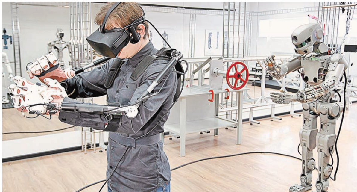
Новейшая разработка российских учёных и инженеров - человекоподобный робот Фёдор, способен повторять движения оператора, поднимать грузы до 10 кг и работать в условиях открытого космоса.
