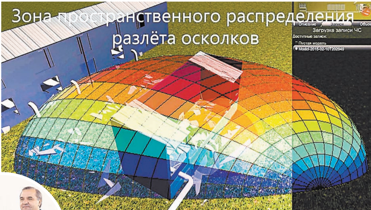
Этот скриншот показывает зону разлёта осколков при взрыве. Специалисты лаборатории определили: радиус поражения ими значительно превосходит радиус поражения взрывной волной. Награду за разработку 3D-модели А. Рыбакову вручил министр В. Пучков.
