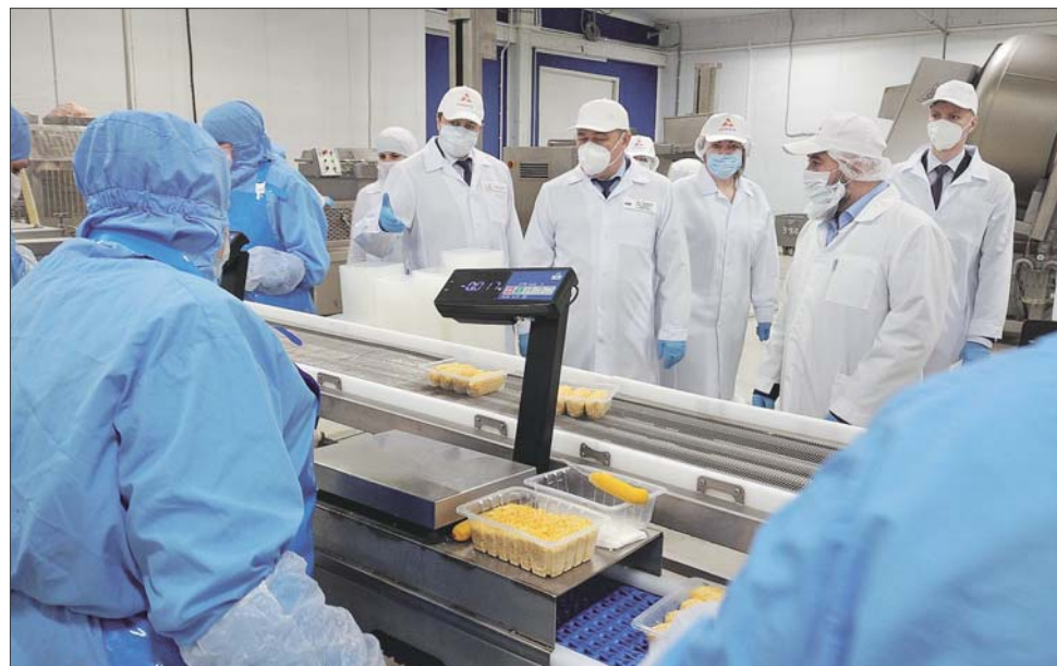
Автоматизированная котлетная линия выпускает полтонны продукции в час.
