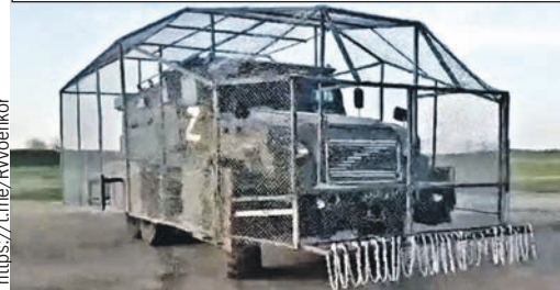
Купол-сетка не закрывает обзор, а цепи снизу - чтобы дрон не прошмыгнул под колеса.
