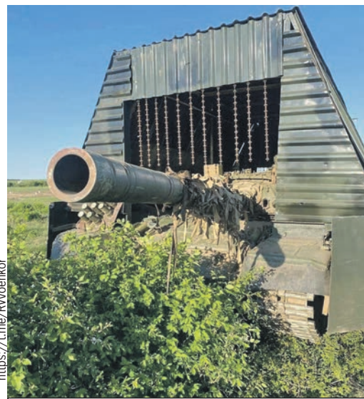
Цепи в амбразуре этого танка-амбара - тоже защита от дронов.
