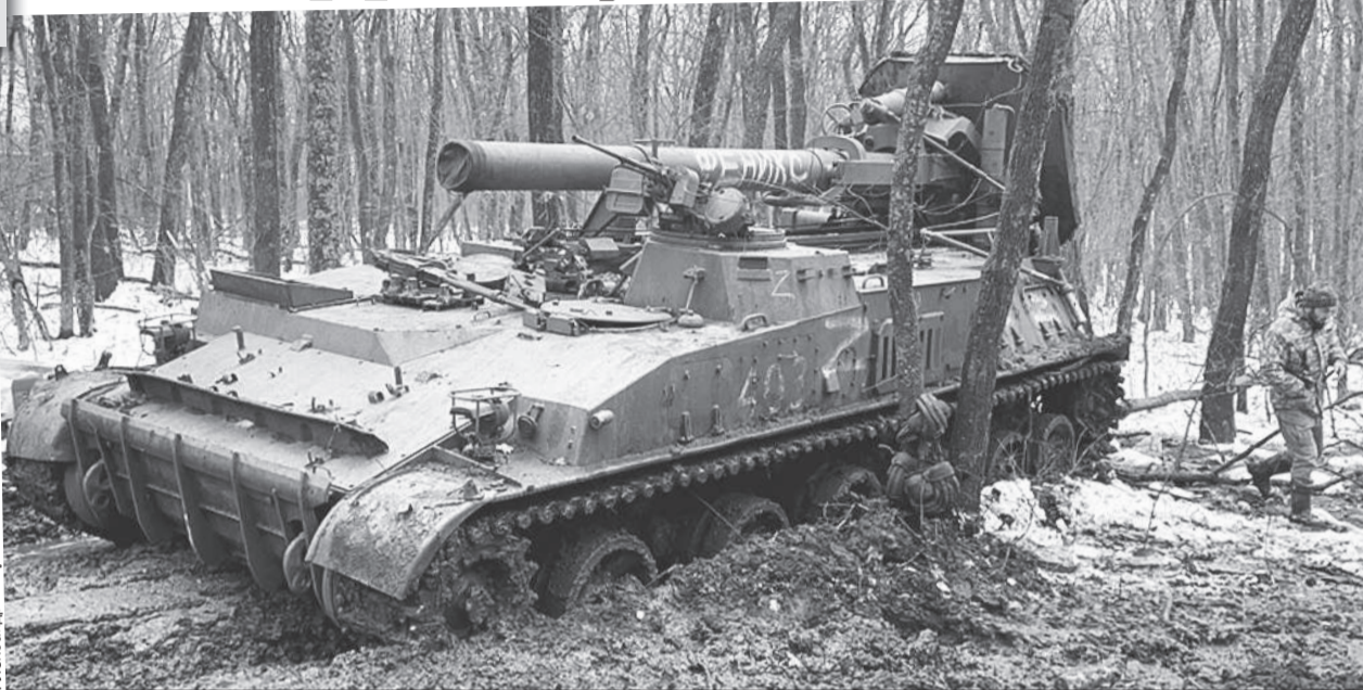
Самый большой в мире самоходный миномет «Тюльпан». Экипаж дал ему имя «Феникс». Такой обязательно выгребет из любой грязи.
