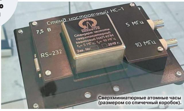
Сверхминиатюрные атомные часы (размером со спичечный коробок).
