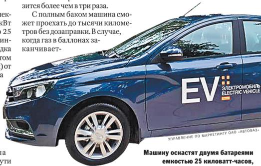
Машину оснащают двумя батареями емкостью 25 киловатт-часов, зарядка от бытовой сети займет около девяти часов.
