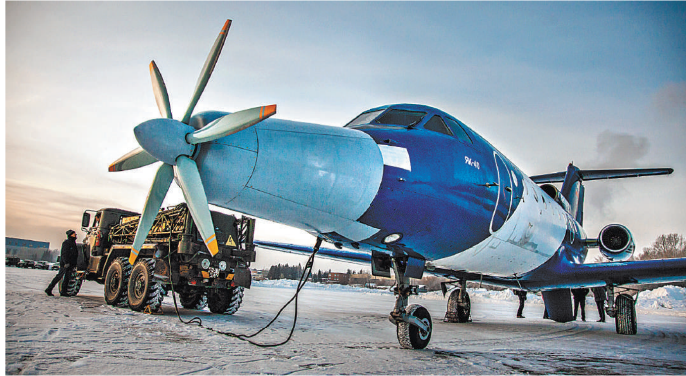
Летающей лабораторией стал Як-40: в его носовой части установлен воздушный винт, который приводится в движение электродвигателем.
