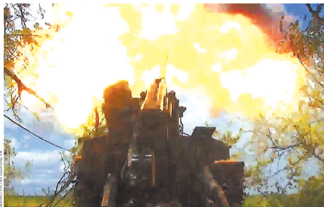
Орудия калибра 152 мм, как правило, стреляют с закрытых позиций, но могут бить и прямой наводкой.
