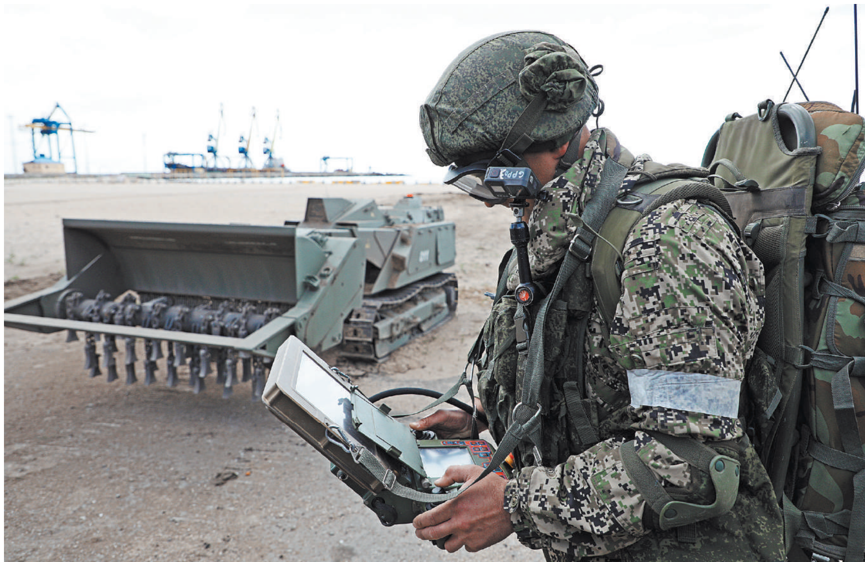
В ходе очистки от взрывоопасных предметов части побережья Азовского моря российские саперы активно использовали робототехнический комплекс разминирования «Уран-Б».
