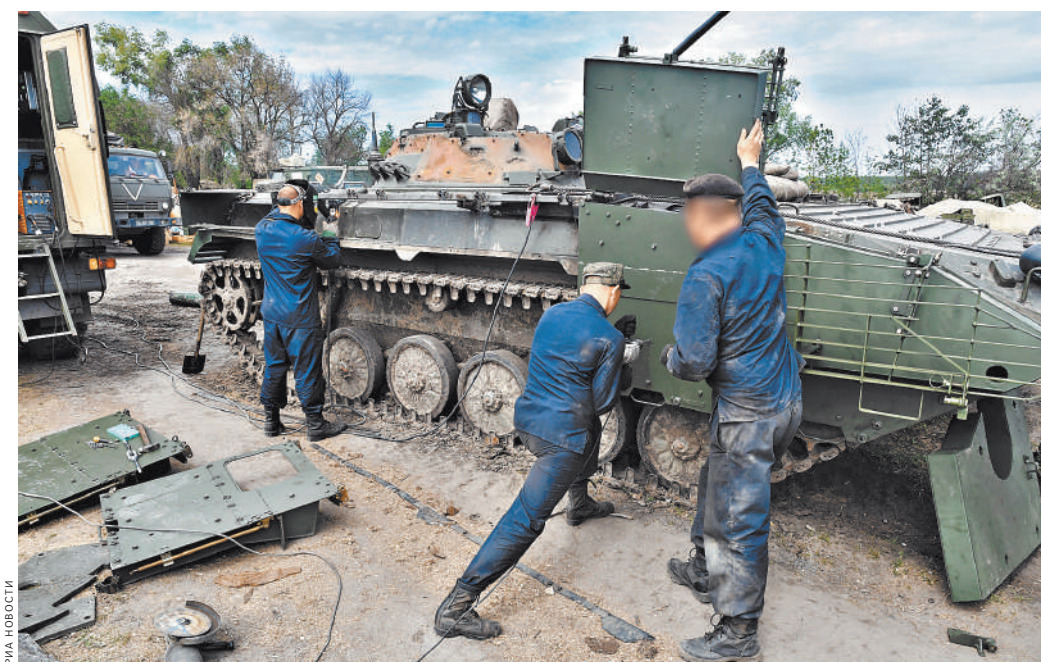
Военнослужащие ремонтно-восстановительного батальона устанавливают дополнительную броню на БМП-2.
