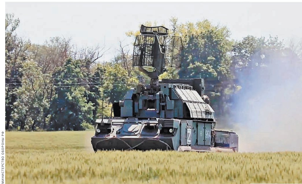
«Тор» — единственный в мире зенитно-ракетный комплекс, который может прицельно стрелять ракетами на ходу.
