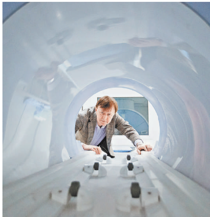
Преимущество российского МРТ — минимальная потребность в жидком гелии для охлаждения сверхпроводников. А в планах — создание аппарата на «сухих» магнитах, вообще не требующих охлаждения гелием.
