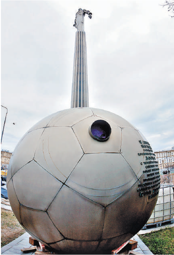
Основная часть памятника выполнена из литого титана, который применяется в строительстве космических кораблей.
