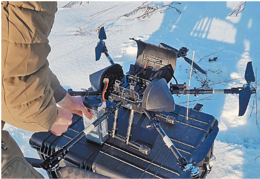
Дрон способен поднимать груз до 4,5 кг, пролететь 45 минут и развить в воздухе скорость до 63 км/ч.
