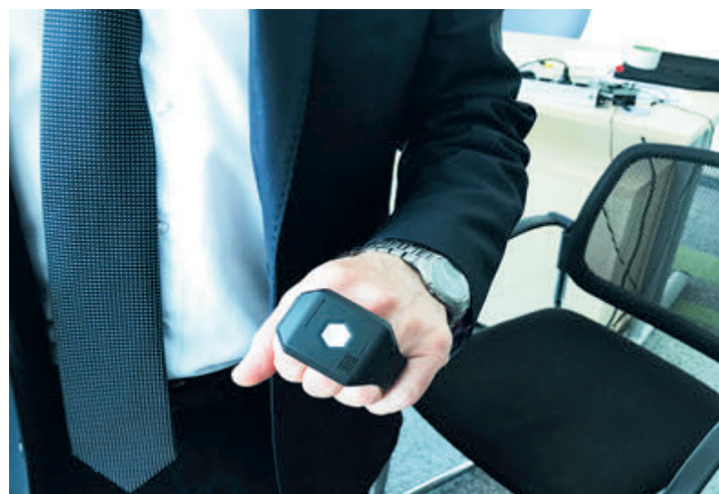
Браслет для бортпроводника. Нажатием кнопки он передает «тревожный сигнал» экипажу и на землю.
