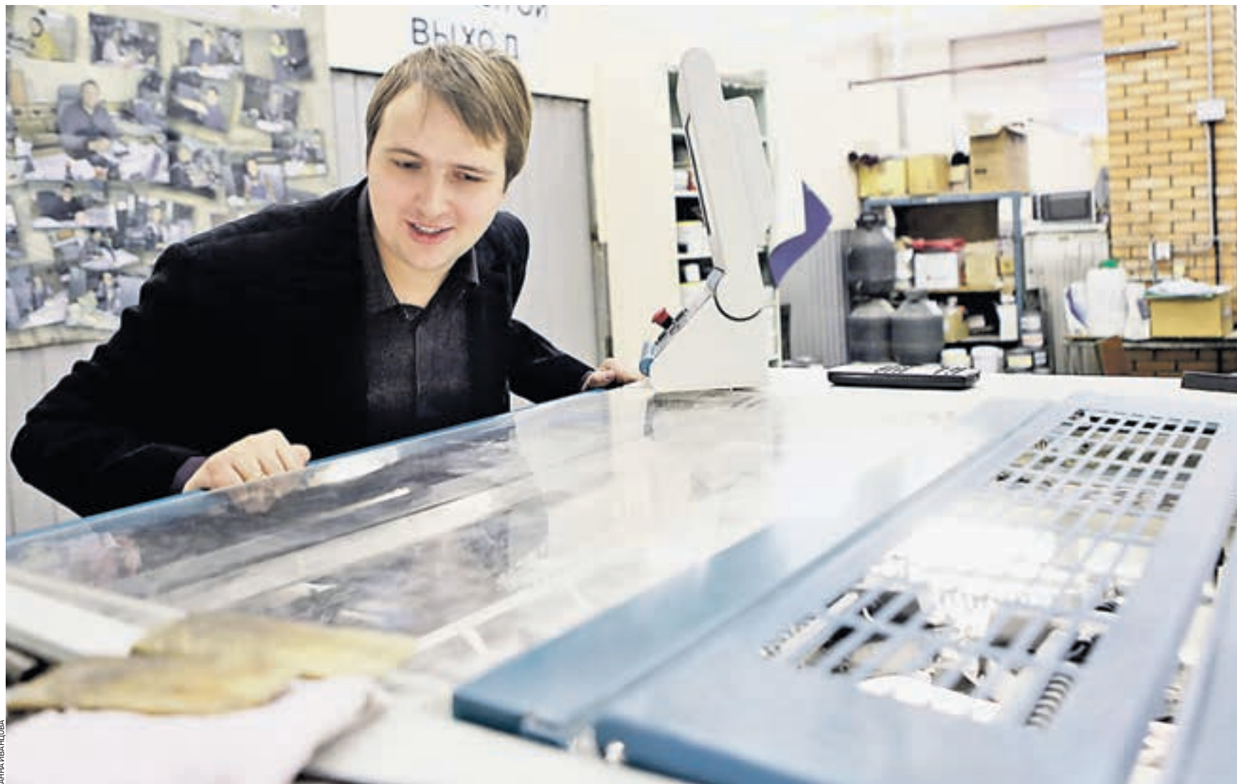
Вчера 14:15 Лауреат городского конкурса «Московский предприниматель-2015», коммерческий директор Дмитрий Ермаков демонстрирует, как работает резальная машина: от точности подрезки зависит размер выпускаемых газет и журналов. Бумага по двум сторонам выравнивается вручную под углом в 90 градусов
