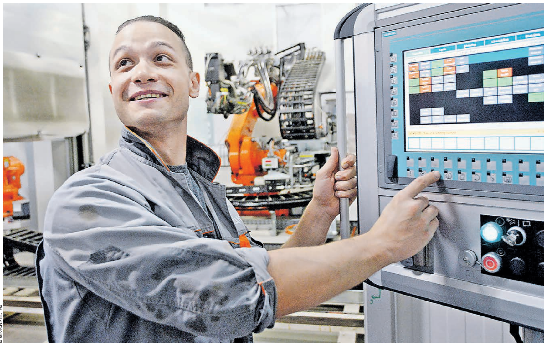
17 августа 2018 года. Оператор сектора прессования Александр Исаев демонстрирует роботизированный станок длинноволоконной инжекции. Специалистов для работы на этом сложном оборудовании полгода обучают в нанотехнологическом центре композитов
