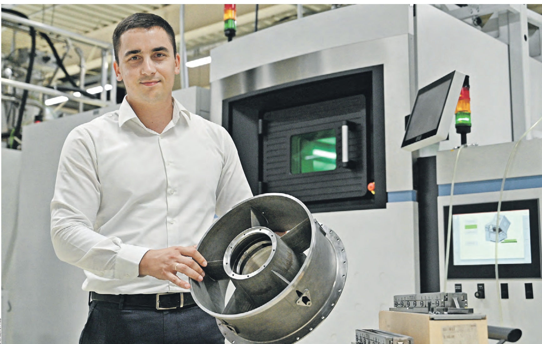
Вчера 11:24 Руководитель группы аддитивного производства ЦАТ Михаил Жеребцов держит деталь наземного двигателя энергетической установки, которая напечатана на 3D-принтере. По такому же принципу в центре создают и элементы авиадвигателей
