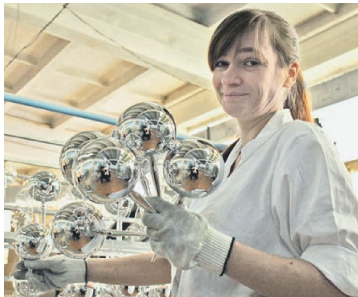
Вчера 13:20 Металлизатор завода елочных игрушек Наталья Молоткова демонстрирует, как на стеклянные шарики наносится слой алюминиевой пыли. Готовые изделия уже можно расписывать красками
