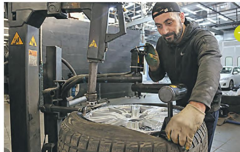
Механик Герасим Григорян снимает шину с диска колеса в одном из столичных автосервисов
